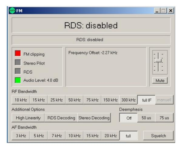
Pour la réception d'une station locale FM, sachant que le spectre est de 75 KHZ pour une station en stéreo il est indispensable de paramétrer le « RF Bandwidth » au delà de 75 KHZ. Idem pour « AF Bandwich » On sélectionnera au minimum 15 KHZ. D'autres options sont disponibles. Votre oreil déterminera votre choix....
