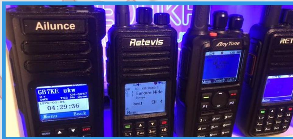
Ces modèles sont pour la plupart, bi-bande VHF/UHF et compatibles avec la FM analogique.
